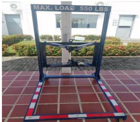
Cuenta con cuatro llantas para que ser transportado sin comprometer la integridad del motor. De ellas, dos son fijas y las otras dos, giratorias. Las ruedas tienen un tamaño de 127.00 mm de altura y 35.56 mm de ancho. El banco
