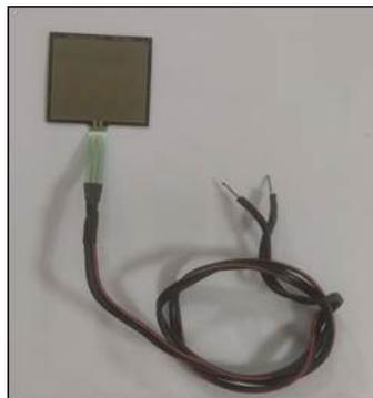
*Nota.* El sensor permite medir valores analógicos, dependiendo de la presión ejercida sobre él.
