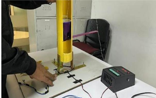
*Nota.* Base para la medición de la fuerza, por distancias establecidas para el direccionamiento de la masa directamente al sensor piezoeléctrico *Nota:* foto tomada por el equipo de investigadores.
