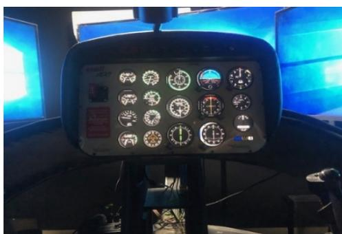
Al finalizar la instalación física de los elementos para la adecuación de un ambiente real similar a la cabina del helicóptero Bell Ranger 206 BIII Series, se procedió a adecuar los instrumentos de vuelo, navegación, propulsión y el tubo de pitot-estático, que permiten al operador la conducción de un vuelo simulado bajo las condiciones e indicaciones propias de una aeronave.
