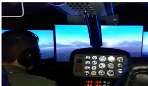
Para las pruebas de control y respuesta a la ejecución de movimientos en los mandos cíclico, colectivo y de control direccional, se realizaron operaciones de vuelo en la plataforma X-Plane, así logrando un espacio de simulación realista para el estudiante.
