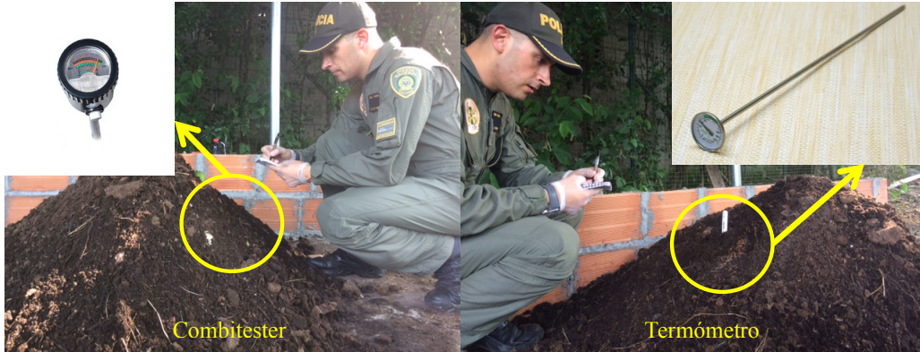
Figura 13 Medición de Temperatura, humedad y pH
