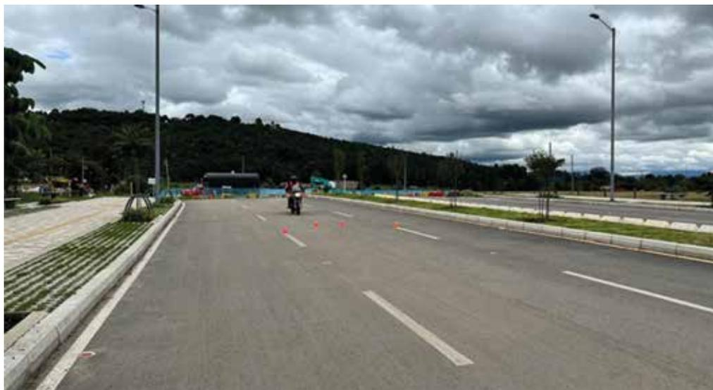
Se ejecutaron diez maniobras de frenado, cinco para la GS500 y cinco para Yamaha BWS, con una velocidad inicial de 40 kph aproximadamente y velocidad final de 0 kph; de forma tal, que dicha desaceleración o maniobra de frenado se realizó de manera normal, sin bloquear las llantas ni ocasionar incomodidad en
