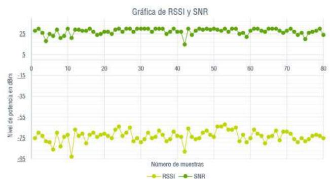
Nota. Muestreo de las variables físicas tomado desde los sensores y niveles de potencia de recepción en equipo terminal.
