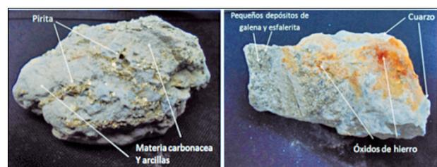
**Figura 1. Resultado de la caracterización macroscópica del mineral de cabeza de mina**
