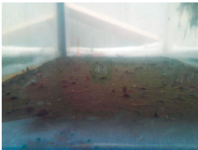
Foto 6. Sólidos sedimentados en el tanque de Lenteja de Agua.
