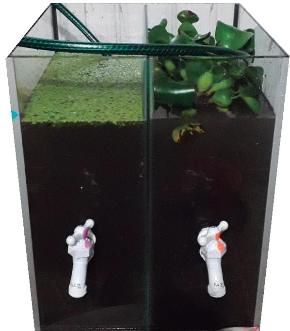
Foto 1. Montaje del filtro de macrófitas en flotación.
