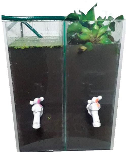
Foto 2. Montaje del filtro de macrófitas en flotación día 1.
