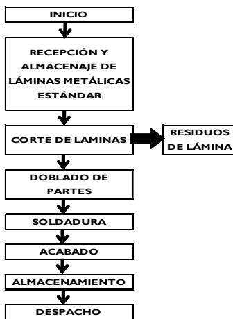
Figura 1. Flujo del proceso para manufactura de armarios metálicos. Fuente: Autora
