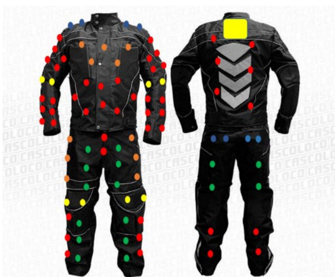
Figura 2 Distribución sensores piezoeléctricos en las zonas corporales del prototipo
