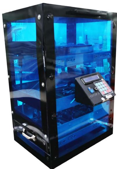
Nota. En la imagen se ilustra el prototipo en físico del sistema de verificación de voltaje de baterías y recarga de proveedores para simuladores de tiro desarrollado en el marco del presente proyecto.
