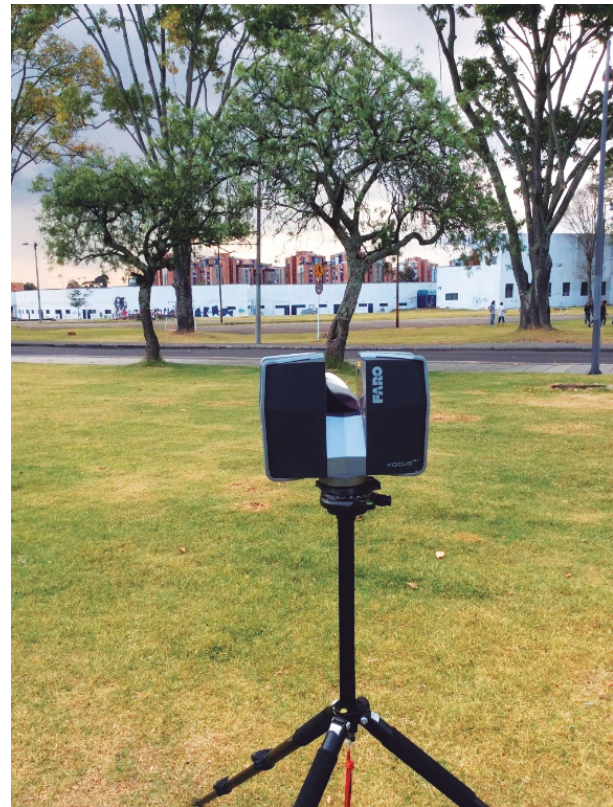
Foto 4. Levantamiento por medio de TLS Faro Focus 3D de la superficie de estudio.
